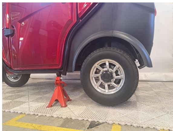
Nosta laitteen vaihdettavan osan puolen takaosa ylös. (koroke).
