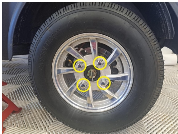
Irrota pyörän kiinnitysmutterit. (hylsy 19 mm).
